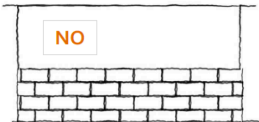
Zoccolatura a più elementi in altezza, non ammessa
