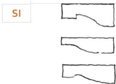
Esempi di modiglioni in pietra, da mantenere e/o ripristinare
